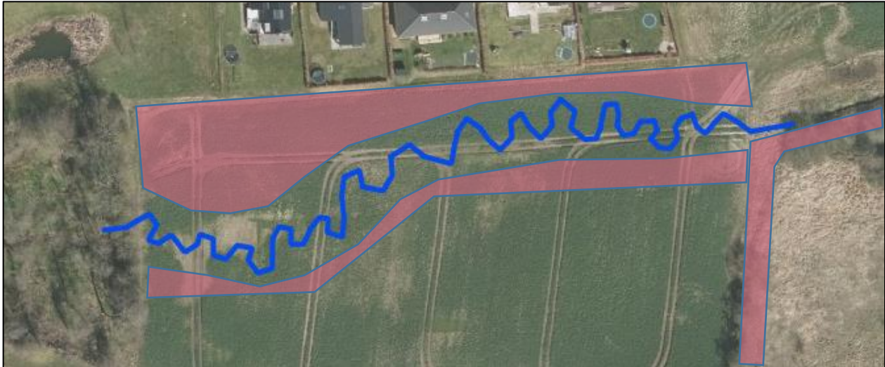
Fig. 7: Placering og indbygning af overskudsjoeden (lys rød markering)
