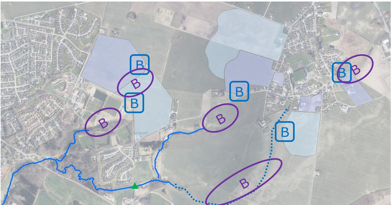
Figur 15: Oversigt over elementer i referencescenariet. Placeringer er omtrentlige. Blå firkanter med "B" viser bassiner indenfor forsyningens serviceniveau. Lilla ellipser med "B" viser skybrudsmagasinering, blå stiplede linje viser regnvandsledning, som åbnes og grønne trekanter viser opdimensionering af rørunderføring. Regnvand afledes i rør indenfor vbyudviklingsområderne, hvilket ikke er illustreret på figuren.
