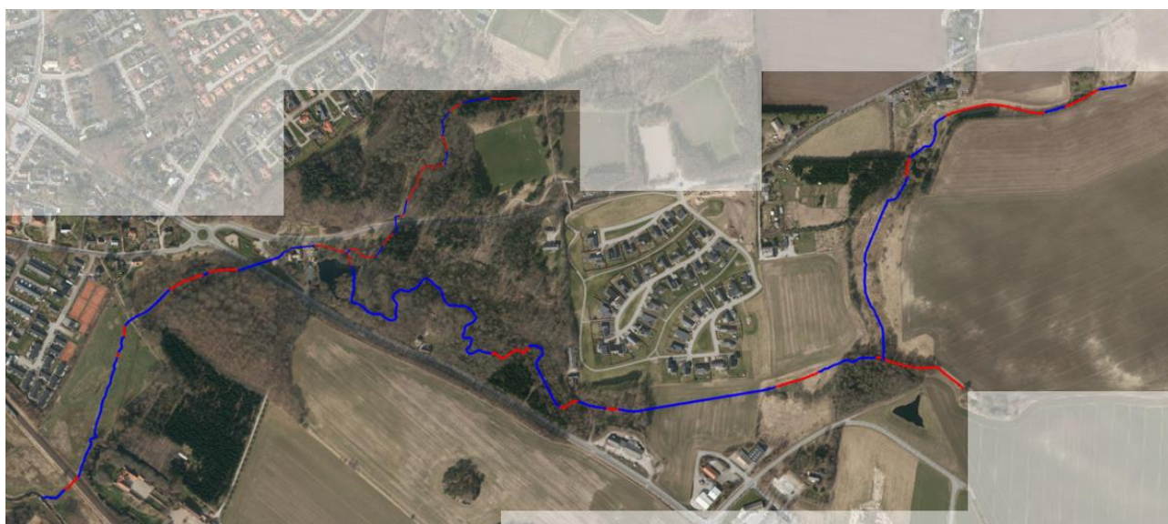
Figur 20: Erosionsrisiko ved udledning på 2 l/s/ha. Kortudsnit fra Orbicon/WSP er sammensat. Røde strækninger viser hvor streampower overstiger 35 W/m.
