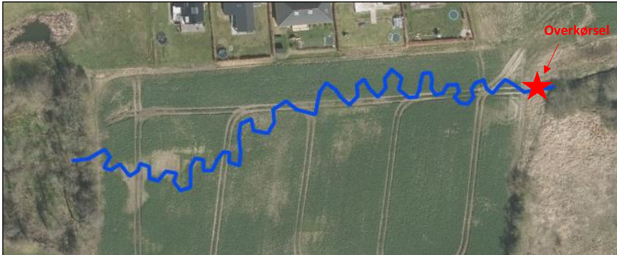
Fig. 6: Skitse af slynget genåbnet forløb af Kollerup Bæk
